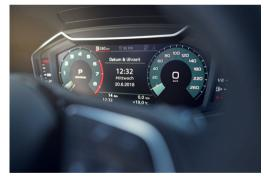
volldigitales Kombiinstrument in 10,25 Zoll mit vielfältigen zusätzlichen Funktionen und Inhalten gegenüber dem digitalen Kombiinstrument (Serie):
